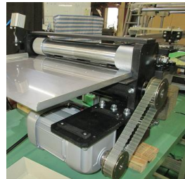
排出ユニット
